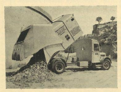
Camión para el servicio de recogida de basura domiciliaria, con descarga de cubos especiales por la parte trasera y dispositivo de prensa para la carga y compresión de la basura, construído con caja de duraluminio, bajo el sistema y patentes
