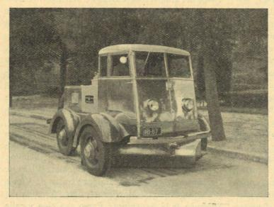
Autobarredora construída según patente «FOC», con motor de tracción trasero, sistema especial de transmisión de movimiento al rodillo barredor; riego previo a la parte delantera del coche y con
