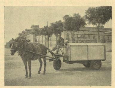
Carro hipomóvil para los servicios de recogida, sobre tres ruedas provistas de neumáticos, con caja de duraluminio, volquete hidráulico construído bajo patente «Ochsner» ->
