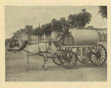
Carricuba de cuatro ruedas, reconstruída, con todo ← el herraje galvanizado y cuba metalizada
