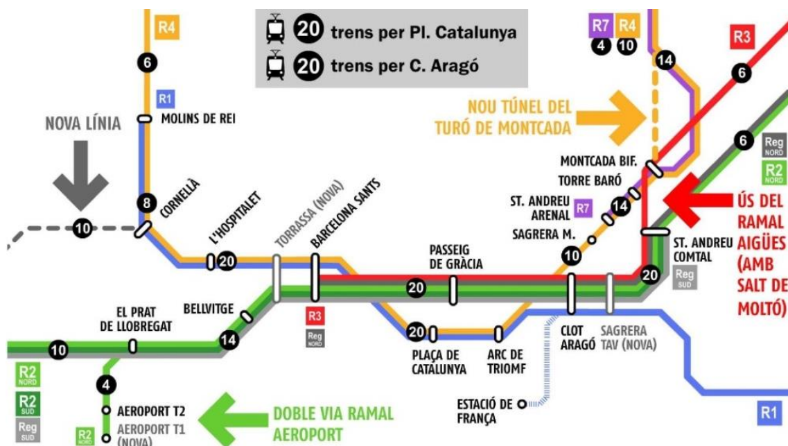
Figura 26. Encaminaments del Pla de Rodalies 2008-2015 amb salt de moltó al Ramal Aigües (no executat), que seria el primer gran guany de capacitat i curt termini.
