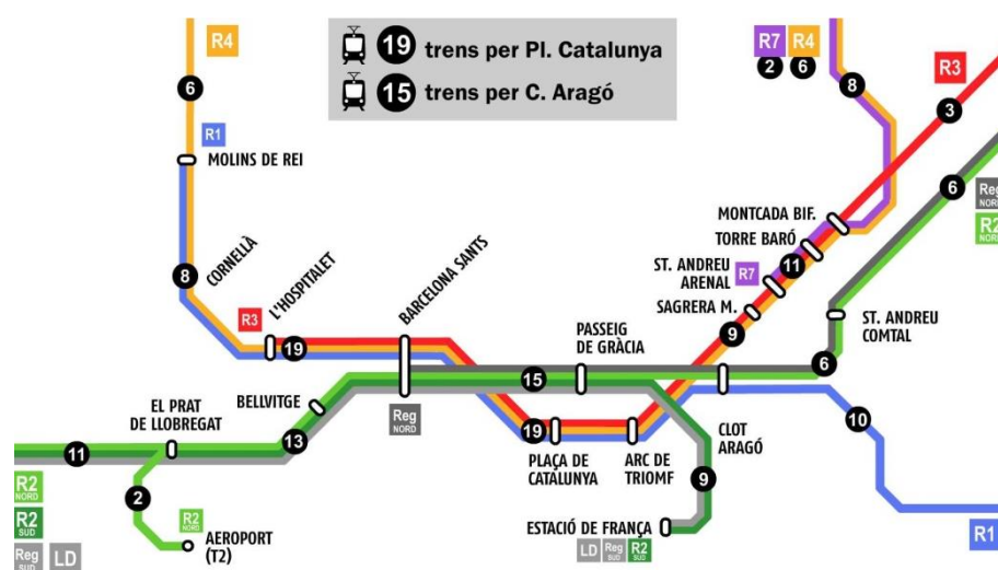
Figura 19. Repartiment actual de circulacions entre el túnel de Pl. Catalunya i del C. Aragó
