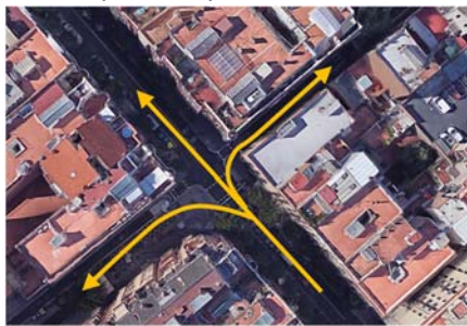
Fase 1: Moviment de pujada Gran de Gràcia i girs a esquerra i dreta dels vehicles.
