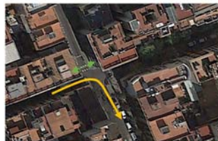
Fase 3: Gir Traversera en direcció Torrent de l'Olla i vianants que travessen Torrent de l'Olla. Fase semafòrica pròpia.
