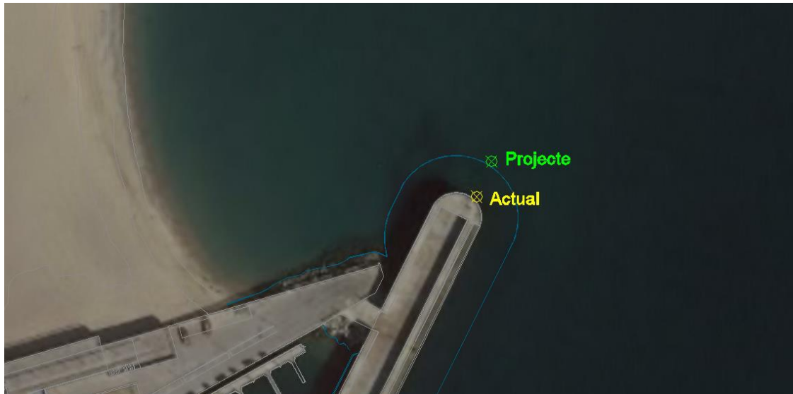
Figura 6. Punts de difracció segons la situació actual i la situació de projecte
