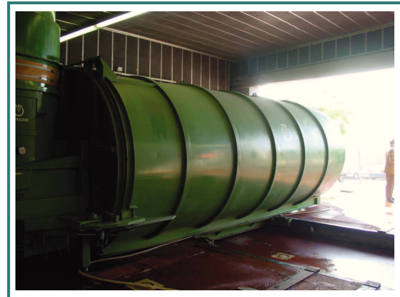
Contenidor de residus tipus, de 30 m 3 de capacitat .
