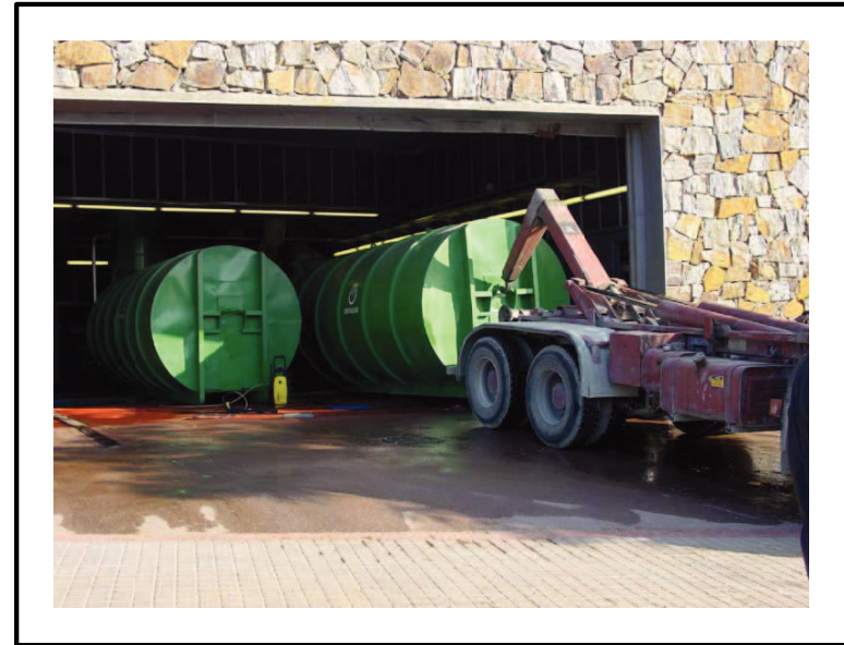
Càrrega d'un contenidor en el camió, per al seu trasllat a planta de tractament.
