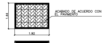
DETALLE TRAMPILLA DE ENTRADA (FUSAC) A ARQUETA PARA VALVULA DE SECCIONAMENTO
