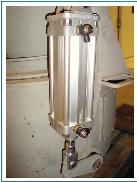
Cilindre pneumàtic per a l'accionament de la vàlvula d'escombraries.
