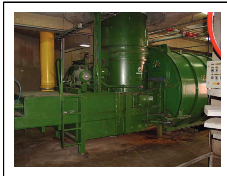
Prensa per a la compactació del residu dins el contenidor.
