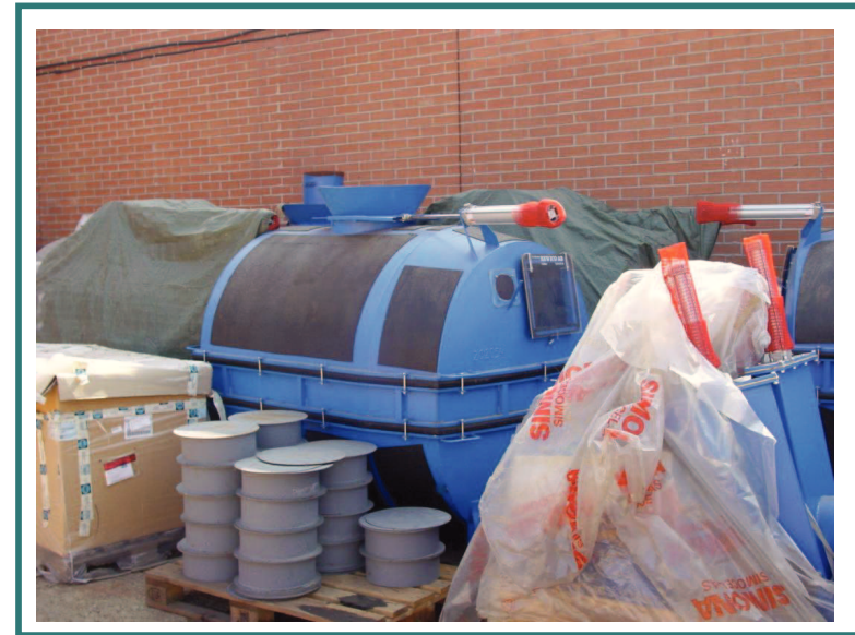
Tanc d'acumulació de residus per a sistemes mòbils, amb 1 vàlvula d'aire i 2 d'obertura i tancament incorporades.
