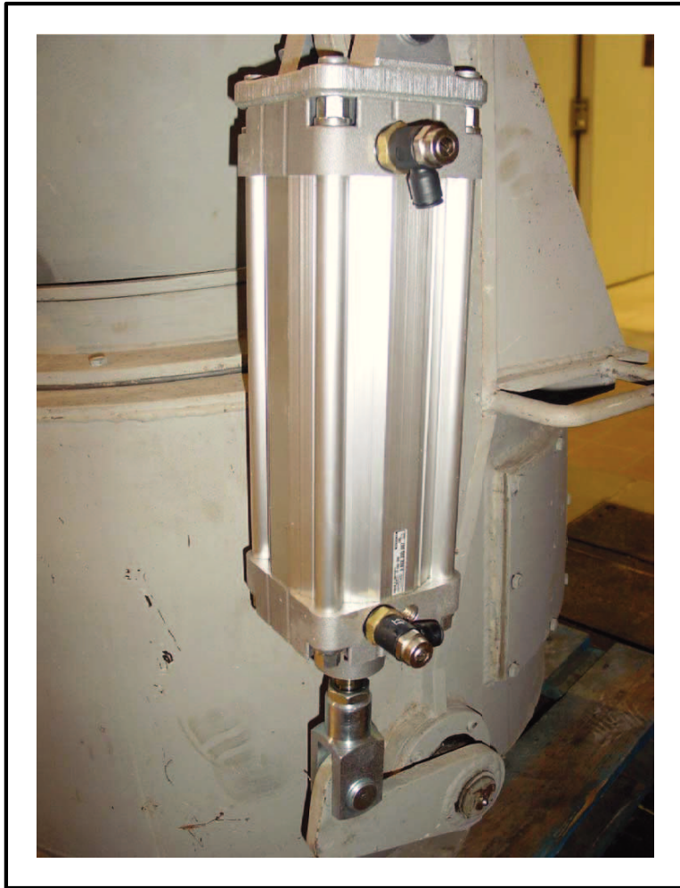
Cilindre pneumàtic per a l'accionament de la vàlvula d'escombraries.
