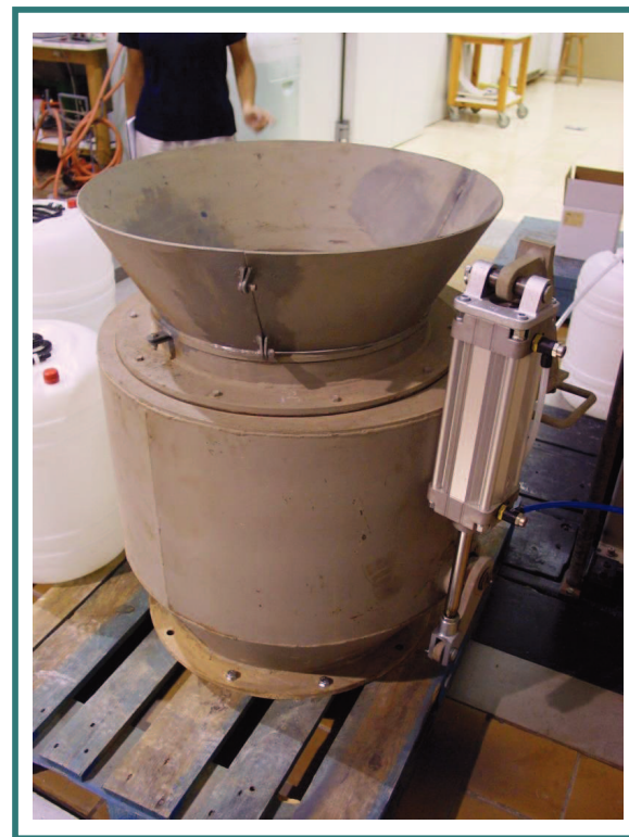
Vàlvula d'escombraries tipus en un sistema fix de recollida.
