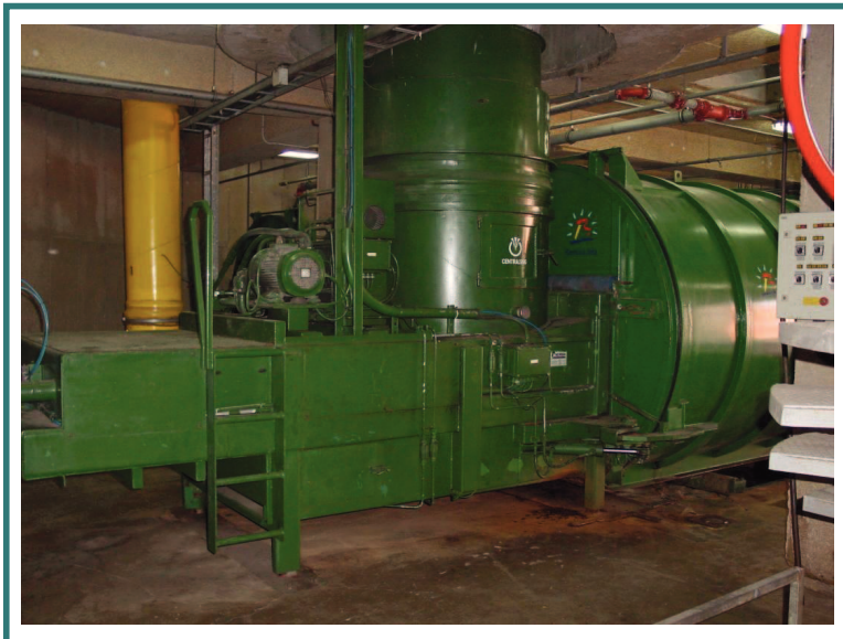
Prensa per a la compactació del residu dins el contenidor.
