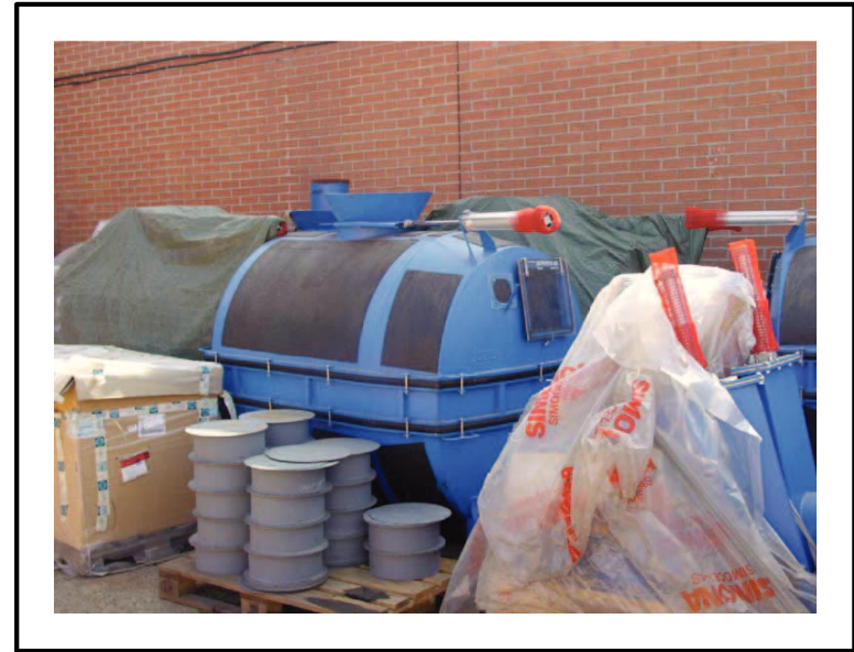
Tanc d'acumulació de residus per a sistemes mòbils, amb 1 vàlvula d'aire i 2 d'obertura i tancament incorporades.
