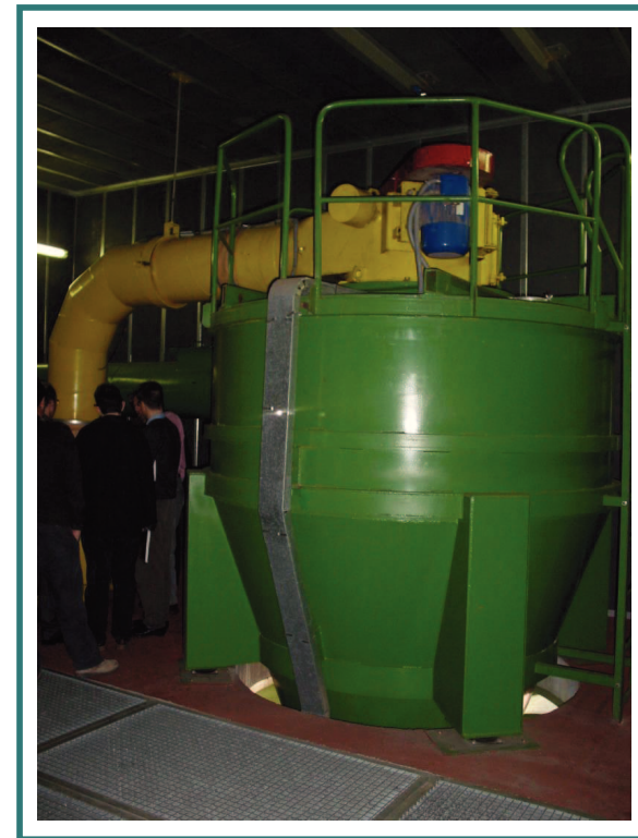
Cicló de separació aire-residu.
