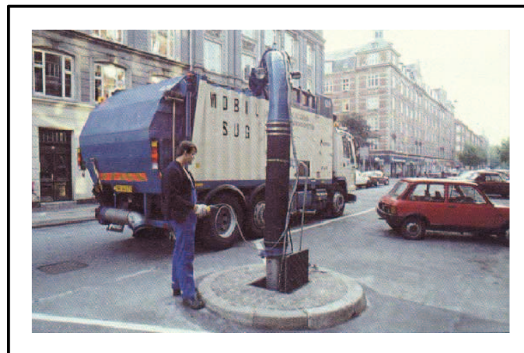
Extracció dels residus amb vehicle de succió, en sistema mòbil de recollida.
