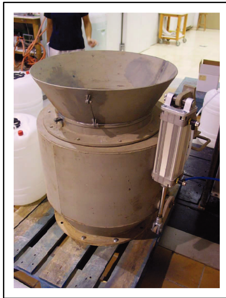
Vàlvula d'escombraries tipus en un sistema fix de recollida.
