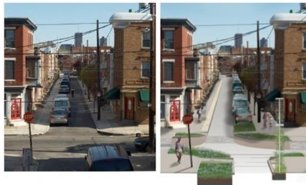
Figura 47: Posible remodelación de una calle vecinal, estrecha y con fuerte pendiente, con pavimento permeable en franjas de acera y línea de aparcamiento, y zonas de biorretención en los puntos bajos (Fuente: City of Philadelphia, 2014. Nombre original: Local Street).
