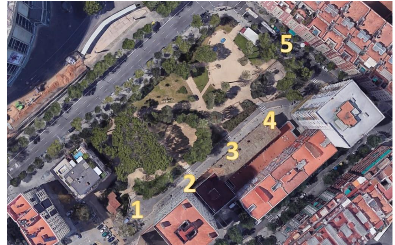
Figura 58: Vista aérea de los Jardines de Bacardí. Los números indican las salidas por las que la escorrentía abandona el parque (Fuente: Google Maps – elaboración propia).
