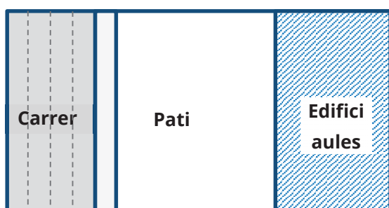
Figura 1. La situació del pati entre l'edifici d'aules i el carrer transitat, redueix l'exposició a la contaminació de l'aire i acústica dins l'edifici
