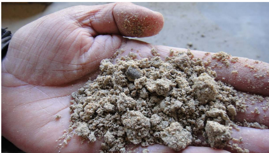
Figura 3: Desadherències, provocades per filtracions d'aigua i lixiviacions de la calç del morter, el morter després, sota la pressió de la ma, mostra la sorra sense calç.
