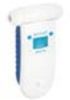
Base Aeroqual 200 amb sensor de NO 2 (diòxid de nitrogen) i de PPM
