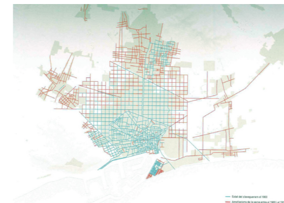
En azul, estado del alcantarillado en 1903, y en rojo, las ampliaciones entre 1903 y 1914. Elaborado por Sergi Garriga a partir de los anuarios estadísticos de la ciudad de Barcelona (Guardia 2011)
