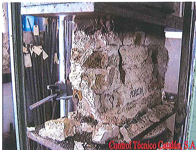
Foto 3. Aparición primeras fisuras
