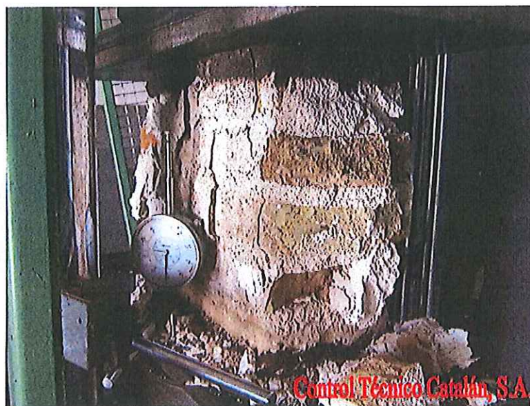
Foto 3. Aparición primeras fisuras
