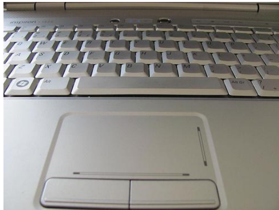
Il·lustració 8: Ratolí tàctil d'un ordinador portàtil. Autoria: Guilherme Ostock. Obra amb llicència CC Reconeixement 2.0 Genèrica
