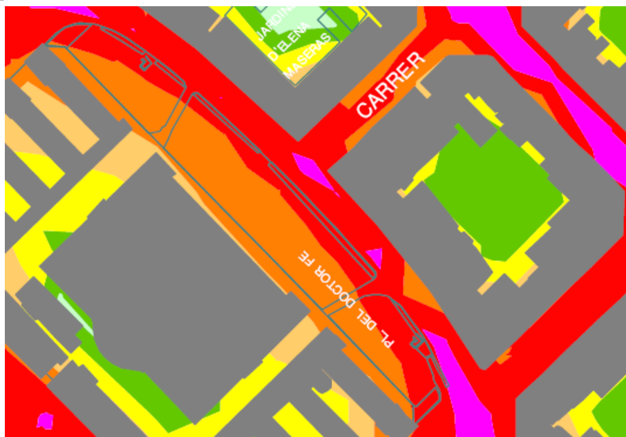
Imatge 10-39 Nivell d'immissió diürn existent a un tram del carrer Casanova
