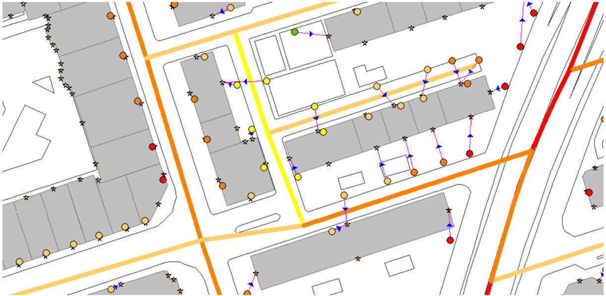
Imatge 9-3 Representació dels nivells de soroll en façana mitjançant trams de vial
