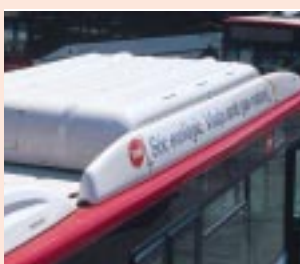
El GNC s'emmagatzema al sostre de l'autobús
