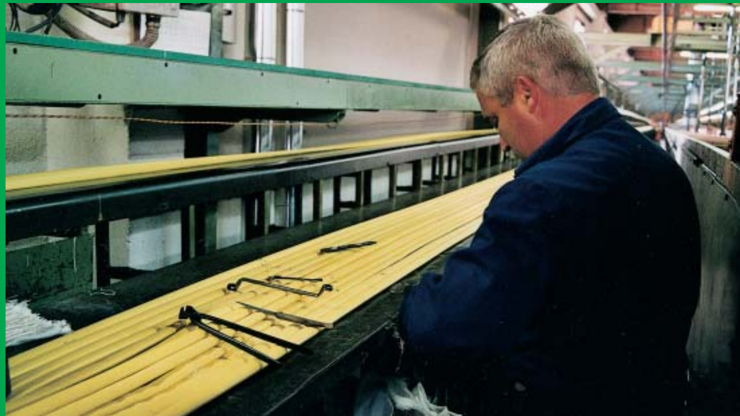
⇒ Comprovació manual de les mànegues sota pressió d'aigua
