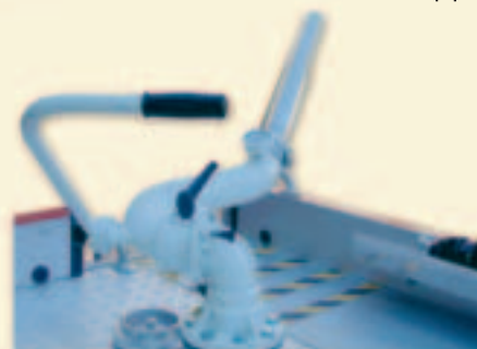
Canó monitor de grans cabdals. Permet llançar indistintament de forma directa aigua o barreja CAF.
