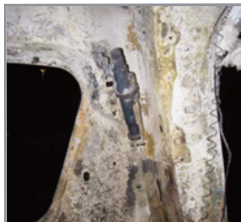
▲ Sobre aquestes línies, un dels diversos components interns del vehicle que pot explotar en cas d'incendi
