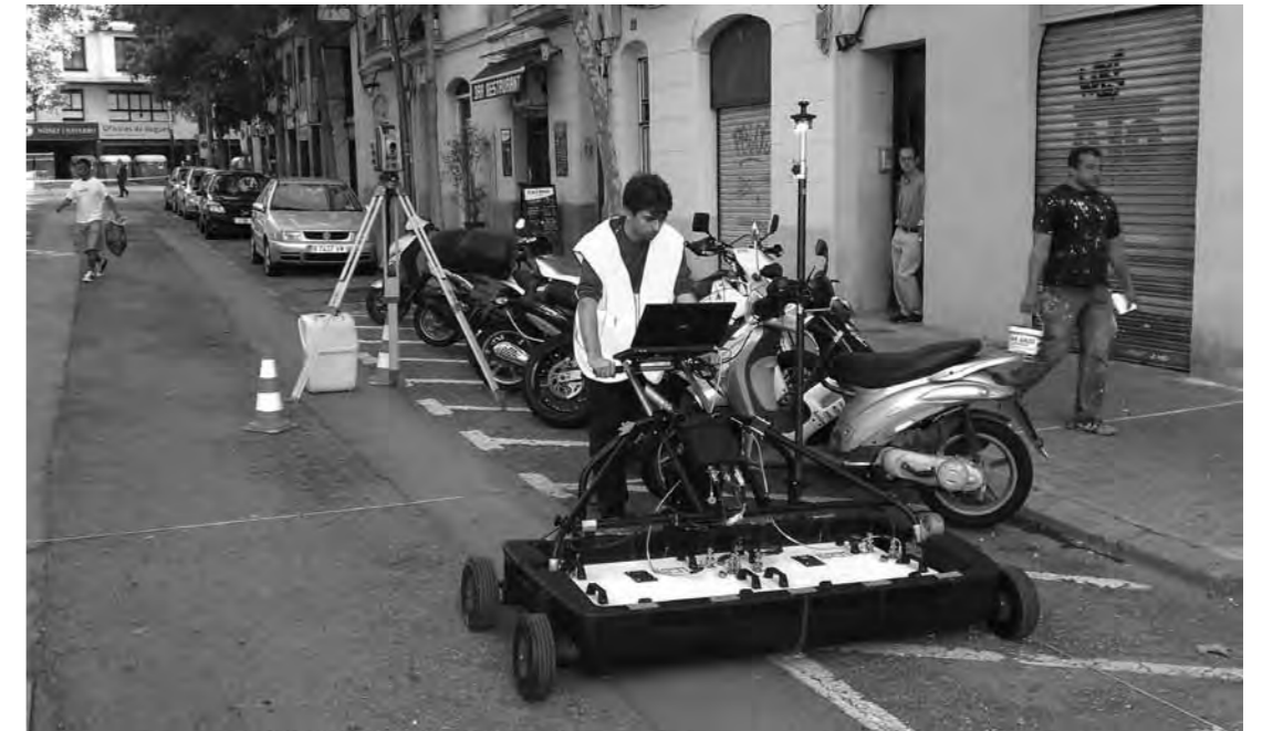
Equip de prospecció compost per georadar i estació total robòtica. Foto: Carles Colás
