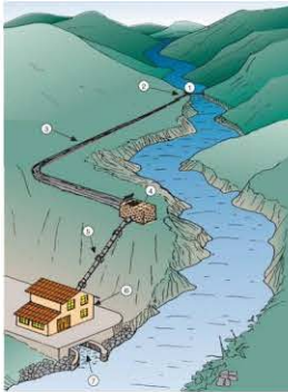
FIGURA 17. INSTAL·LACIÓ MINI-HIDRÀULICA D'AIGUA FLUENT
